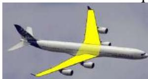
Trapézoïdale en flèche
