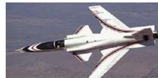
Trapézoïdale en flèche inversée (Grumman X29)
